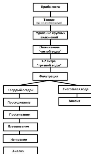
Рисунок 3.1.1 – Пробоподготовка проб сугробного покрова [37]
