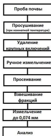
Рисунок 3.1.2 – Пробоподготовка проб почвы [37]
