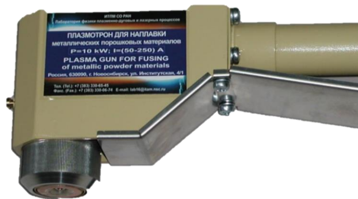
Рисунок 23 – Плазмoтрон для напыления порошковых материалов [79]
