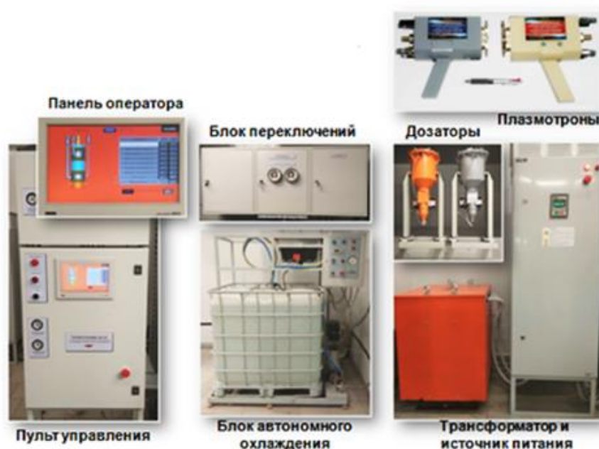
Рисунок 22 – Установка воздушно-плазменного напыления порошков «Термоплазма 50-01» [78]
