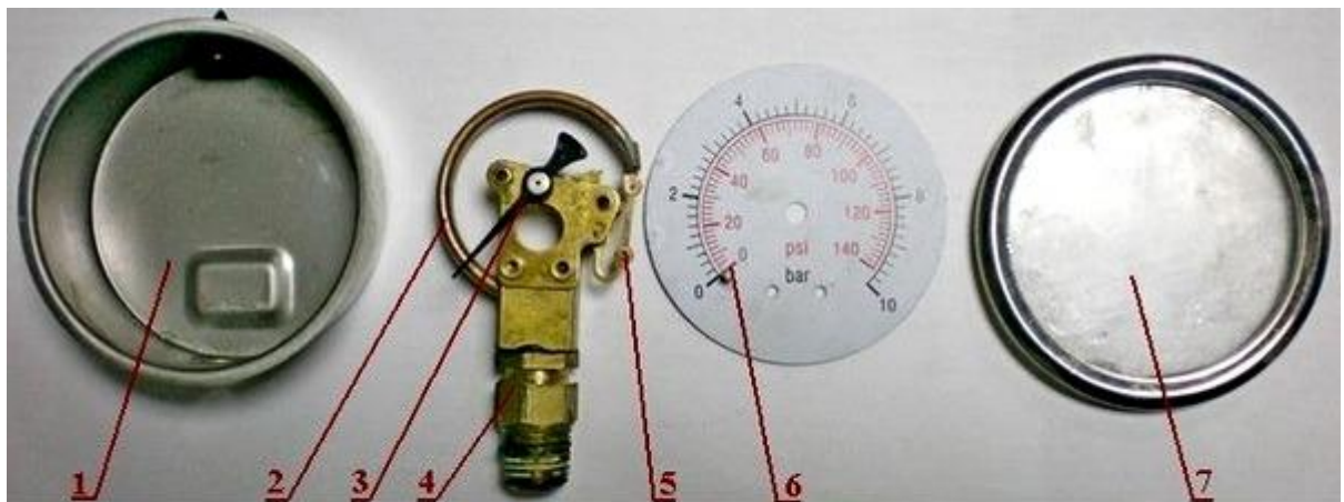
1- Корпус прибора. 2- Трубка Бурдона. 3- Стрелка. 4- Штуцер 5- Рычажно-зубчатая передача. 6- Шкала. 7- Стекло.
