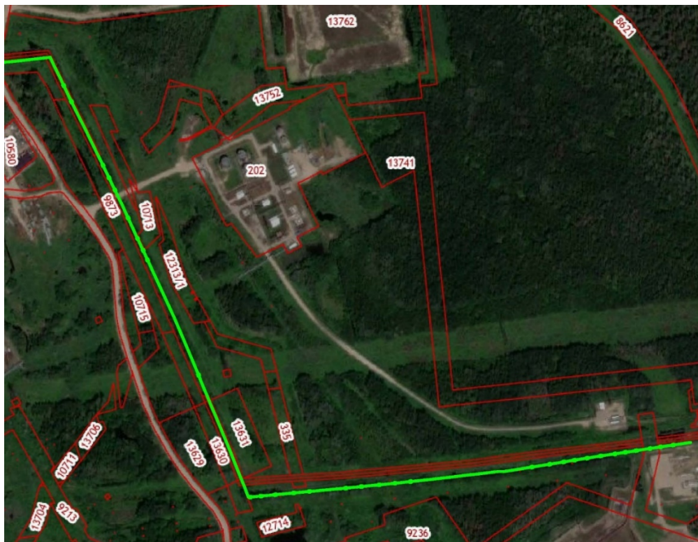
Рисунок 8 – Фрагмент размещения трассы кабельной эстакады
