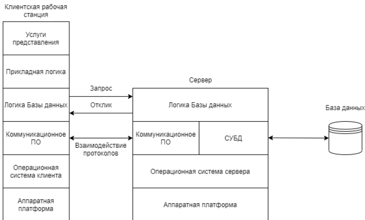
Рисунок 1.2 – Архитектура клиент-сервер для баз данных
