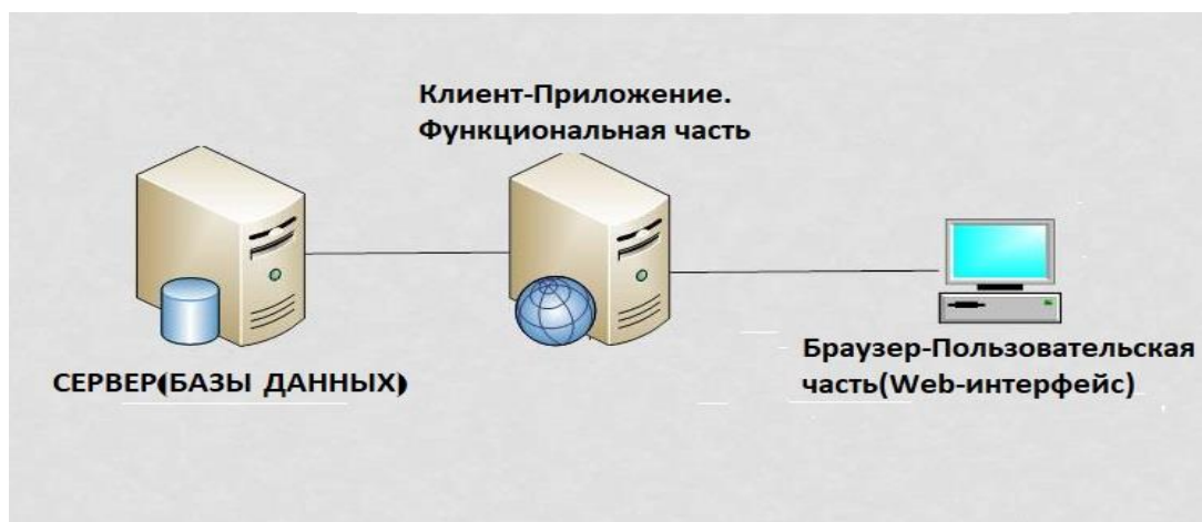
Рисунок 2.17 – Трёхуровневая архитектура информационной системы
